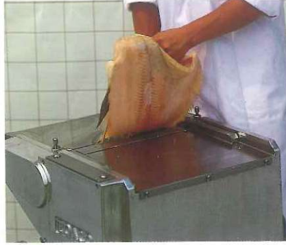
②歯付きローラーが皮を確実にカット部へ送り込みます。 The skin is fed to cutting area by a roller with its teeth.
