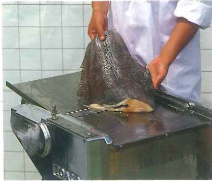
①皮を下にして、歯付きローラーの上へのせます。 Put the skin to be downward on the toothed roller.
