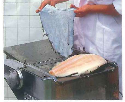
③剥き残しがなく、皮のみをカットします。 It's to remove only the skin without any remain.
